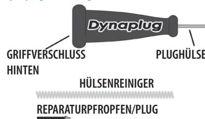
6. Griff vollständig herausziehen. Der Pflöpfen verbleibt im Loch. Für die meisten Schäden, verursacht durch einen Nagel oder eine Schraube genügt ein Pflöpfen/plug. Reifen aufpumpen und kontrollieren ob Luft entweicht. Sollte noch Luft entweichen, einen zweiten Pflöpfen einführen.
